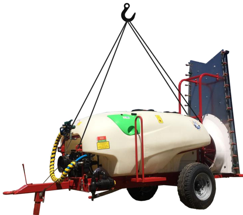
Рисунок 15.1 — Схема строповки опрыскивателя.
